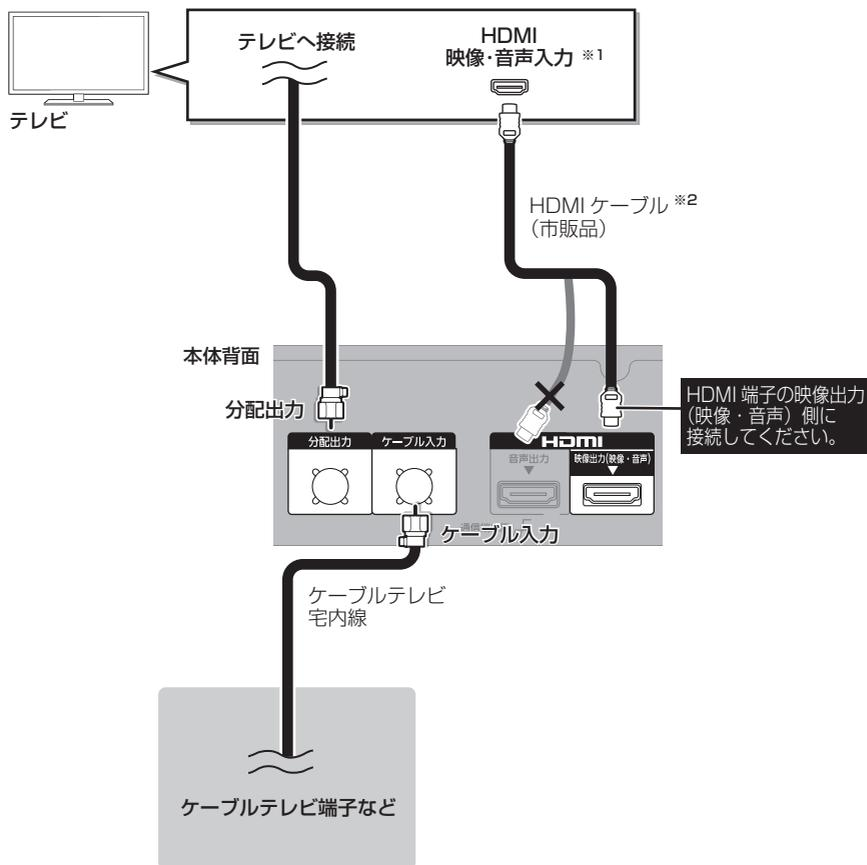
※ 1 高画質な 4K 放送を視聴していただくには、4K 対応テレビ (HDMI 2.0/HDCP2.2 対応端子搭載) に接続してください。
