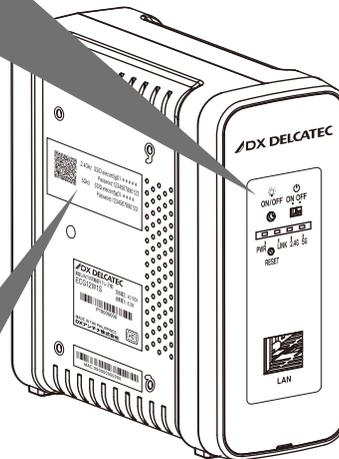
無線LAN付き同軸線モデム(子機)の左側面にあるシールに記載されている、SSID(ネットワーク名)とパスワード(セキュリティキー)をご確認ください。
